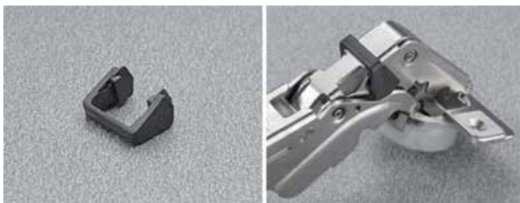
Arrêt pour charnières Silentia+ avec angle d'ouverture 155° - arrêt à 135°
